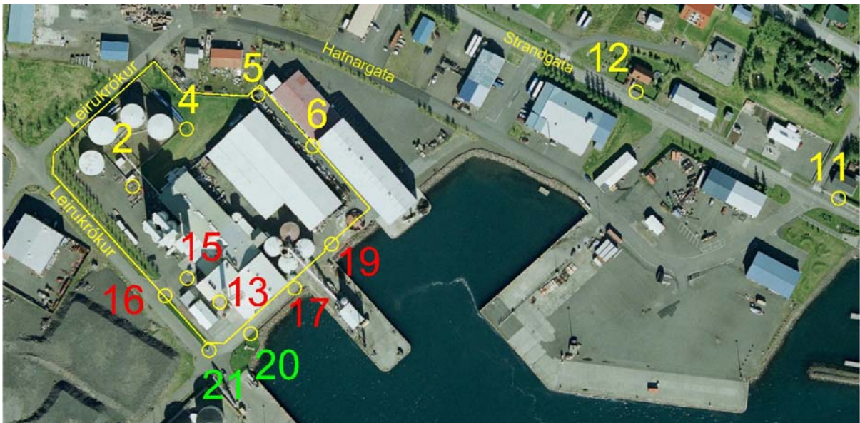
Mynd 3. Staðsetningar hávaðamælinga við fiskmjölsverksmiðju Eskju hf. Lóðamörk eru sýnd með gulum feril. Gular mælingar eru frá 9. mars, rauðar frá 27. mars og grænar frá 29 mars, (Mynd: Loftmyndir ehf.)
