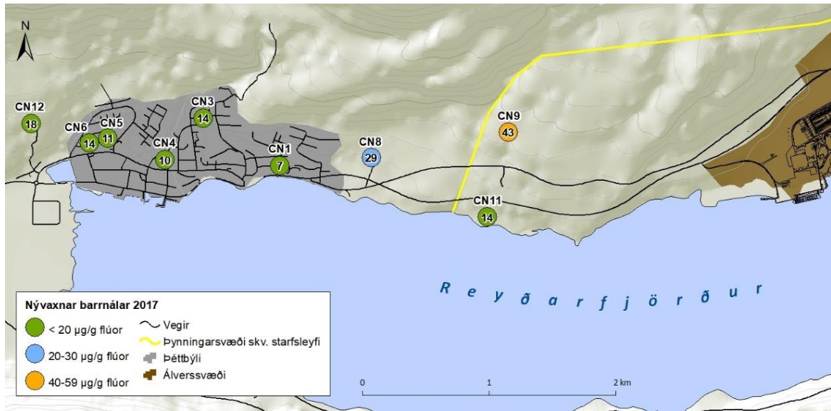
Mynd 42. Sýnatökustaðir barnála í Reyðarfirði og styrkur flúors í nývöxnum barnálum (CN) í október 2017 (Landmælingar Íslands, 2013 og 2015).
