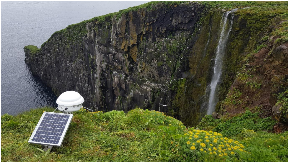
3. mynd. Vöktunarmyndavél af „Cyclapse“ gerð frá Harbortronics horfir yfir hluta Langakambs í Hælavíkurbjargi. Sólarrafhlaða sér um að halda búnaðinum gangandi árið um kring. – A time-lapse camera in the Harbortronics Cyclapse housing and mounting system, overlooking a plot in Hælavíkurbjarg cliff.
