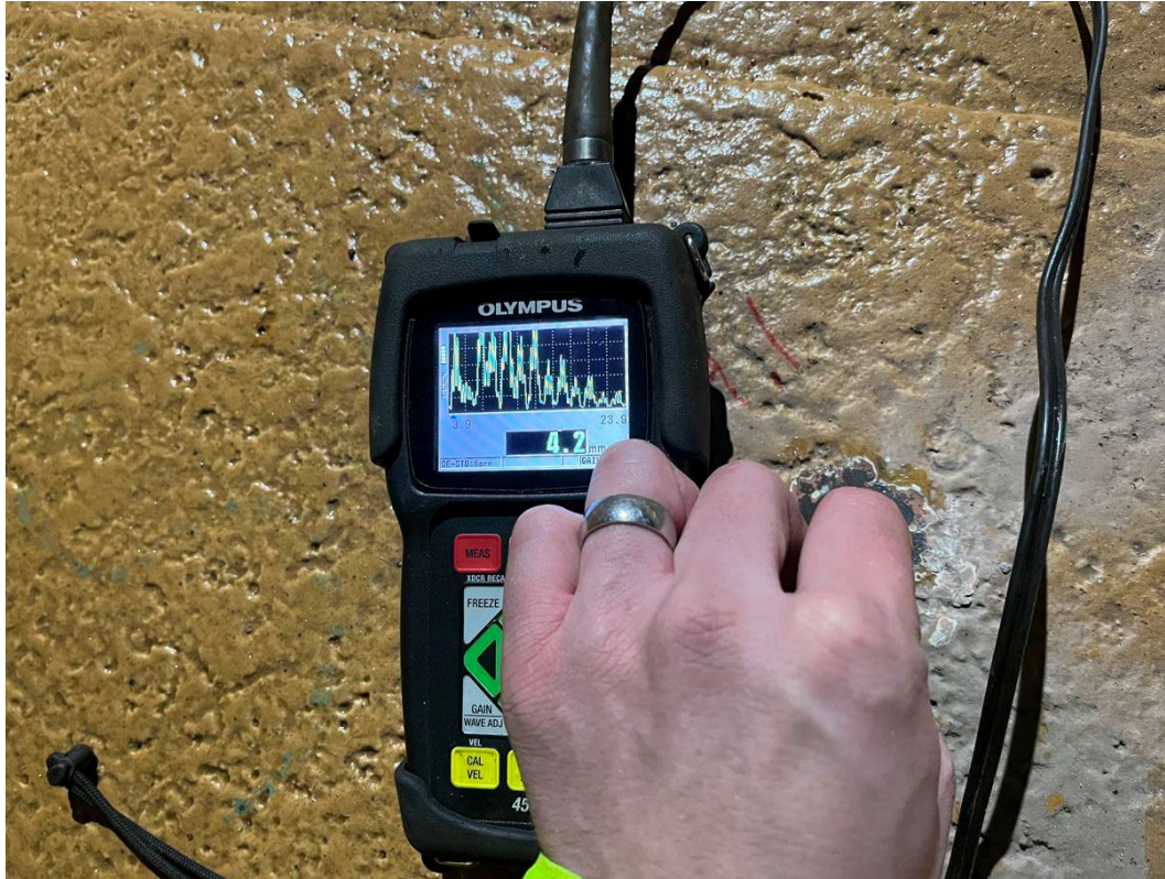
Mynd 5. Þau svæði sem skanni gaf tilkynna um efnisþynningu voru þykktarmæld.
