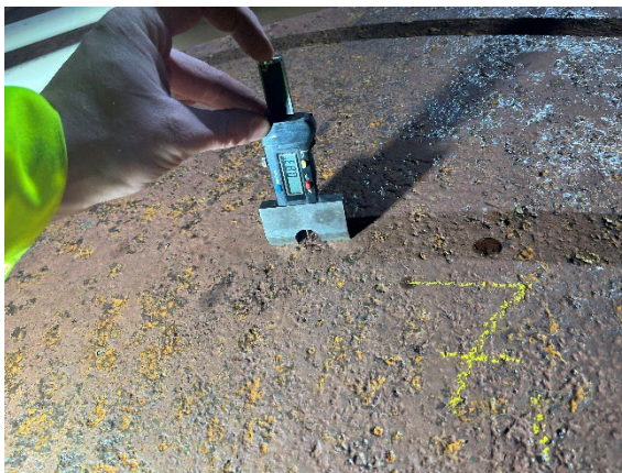
Myndir 1-6. Dæmi um suðupunkta sem eru viðá um gólf og svo tæringu frá fyrri tíð.
