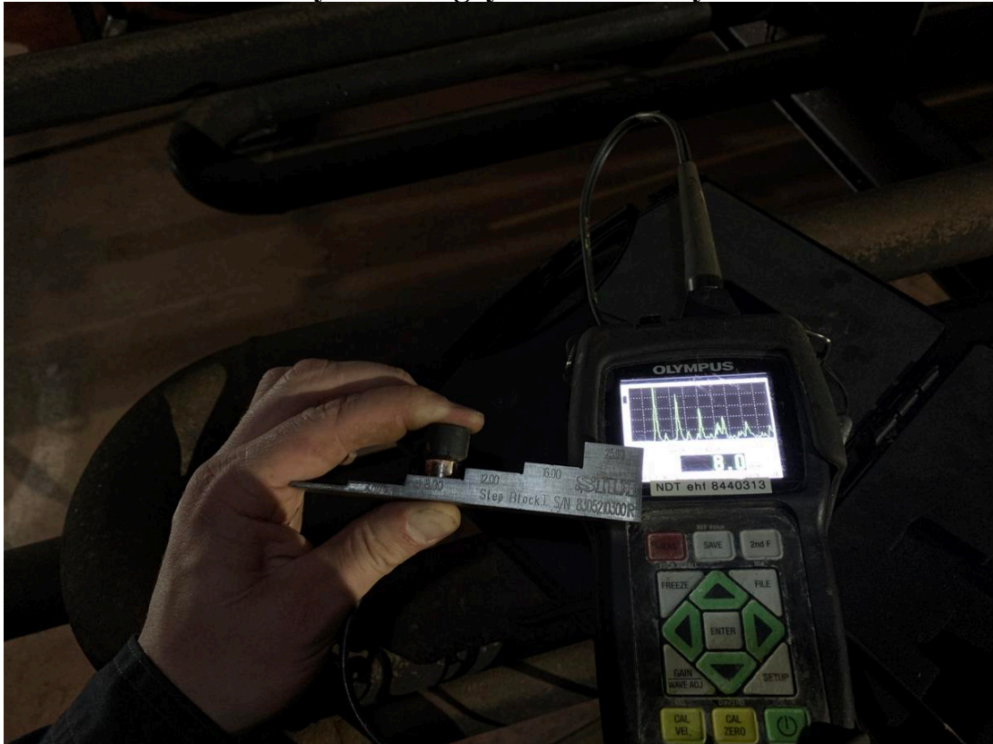
Mynd 1. Mælir prófaður á kvörðunarbökk áður en mælingar hefjast.
