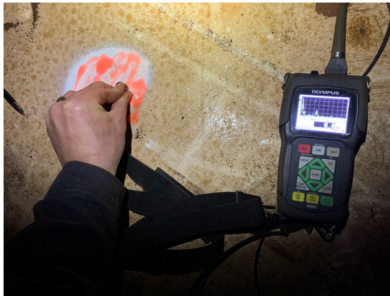
Mynd 1. Blettur mældur. Efnisþykkt reyndist 4,5mm
