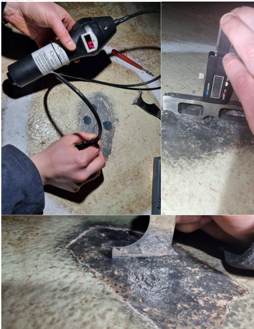
Myndir 9-10-11. Myndir frá Olíudreifingu sem sýna mælingu á pytt sem fannst með skanna.
