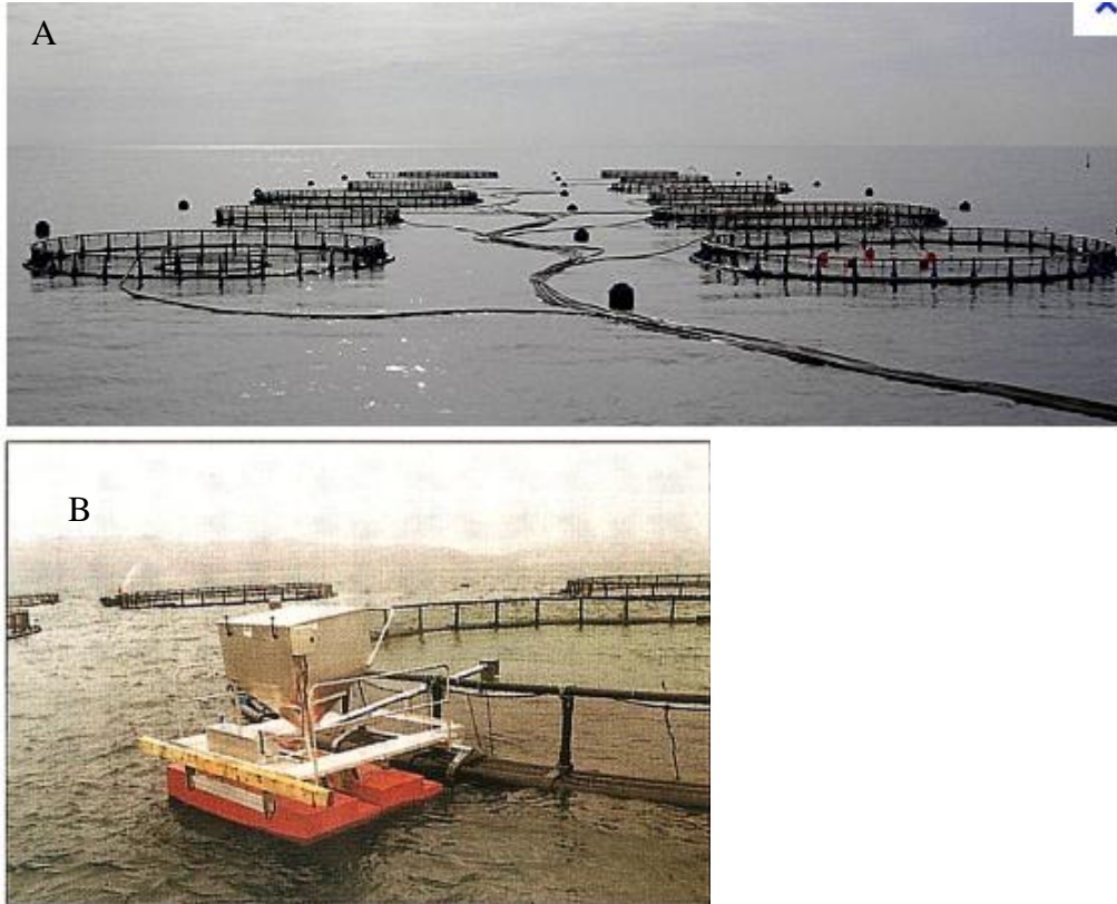
Mynd 3. Fóðrun í sjókvíum. Mynd A sýnir fóðrun með fóðurkerfi í landi og mynd B sýnir fóðrara við sjókvíar.
