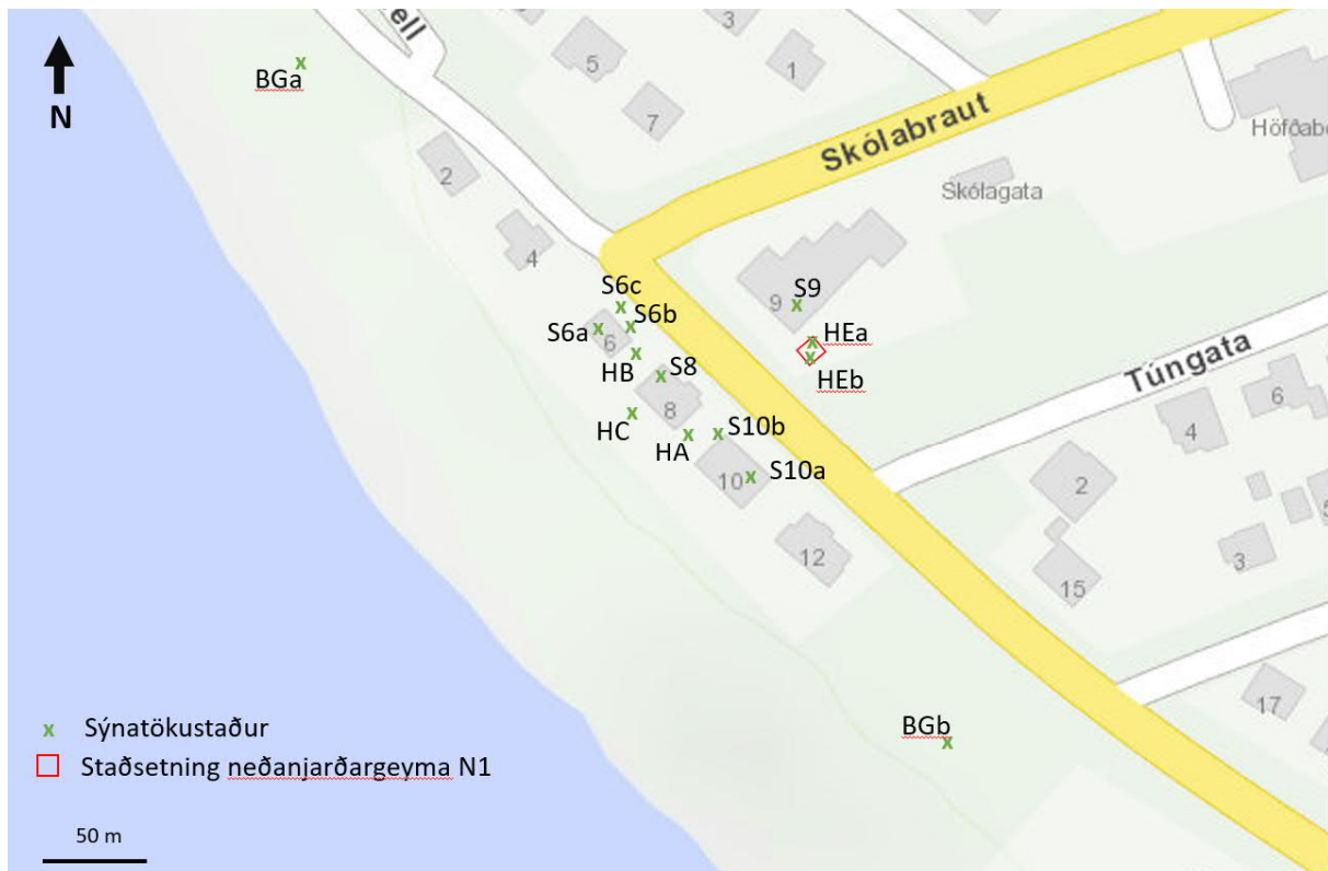
Mynd 3 Sýnatökustaðsetningar á TVOC mælingum: Bakgrunnsgildi (BGa og BGb), loftunarrör (HA, HB, HC, HEa og HEb), innandyra (S6a, S8, S9 og S10a), úr útsogi undan botnplötu (S10b og S6c) og útsogi úr skurði (S6b). Grunnmynd fengin af ja.is.
