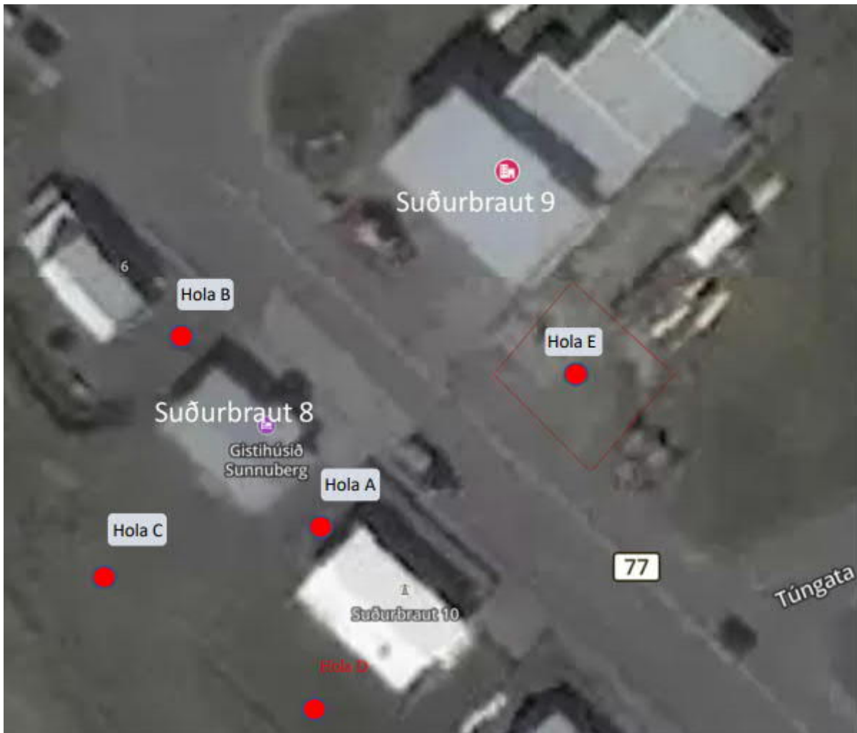
Mynd 2 Fimm loftunarrörum hefur verið komið fyrir í holum A, B, C og E. Ekki var komið fyrir loftunarröri í holu D (N1, 2020).
