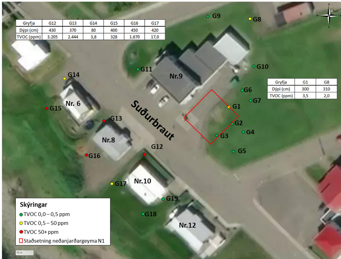
Mynd 3 Yfirlitsmynd yfir mæld TVOC-gildi í gryfjum og dýpi þeirra. Tölur sýna hæst mæld gildi í þeim gryfjum þar sem TVOC mældist >0,5 ppm. Loftmynd fengin af ja.is
