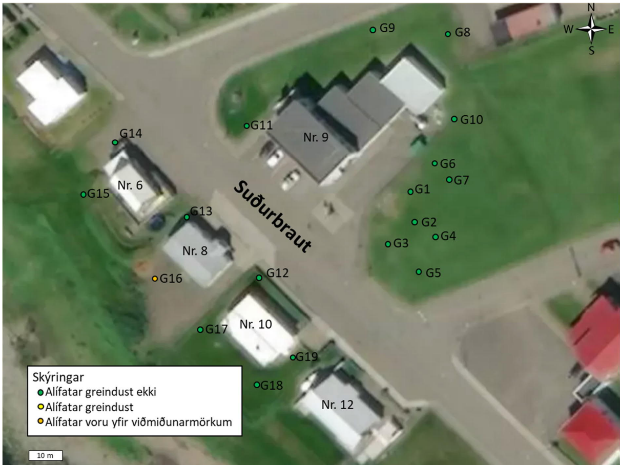
Mynd 8 Yfirlitsmynd yfir mæld gildi alifatískra efna úr gryfjum á rannsóknarsvæðinu. Engin viðmiðunarmörk eru til í íslenskum reglugerðum eða leiðbeiningum, svo hér er stuðst við sænsk viðmiðunargildi skv. bréfi Umhverfisstofnunar (2021b). Loftmynd fengin af ja.is.
