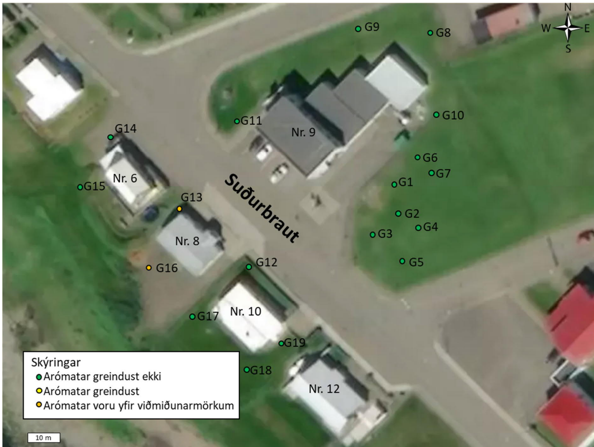
Mynd 9 Yfirlitsmynd yfir mæld gildi arómískra efna úr gryfjum á rannsóknarsvæðinu. Engin viðmiðunarmörk eru til í íslenskum reglugerðum eða leiðbeiningum, svo hér er stuðst við sænsk viðmiðunargildi skv. bréfi Umhverfisstofnunar (2021b). Loftmynd fengin af ja.is.
