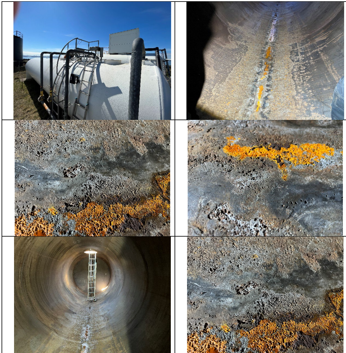
Blettir í gólfi mælast 0,5 - 1,5 mm djúpir. Breidd svæðis er u.þ.b 400 mm breitt og nær eftir allri lengd tank T2008
