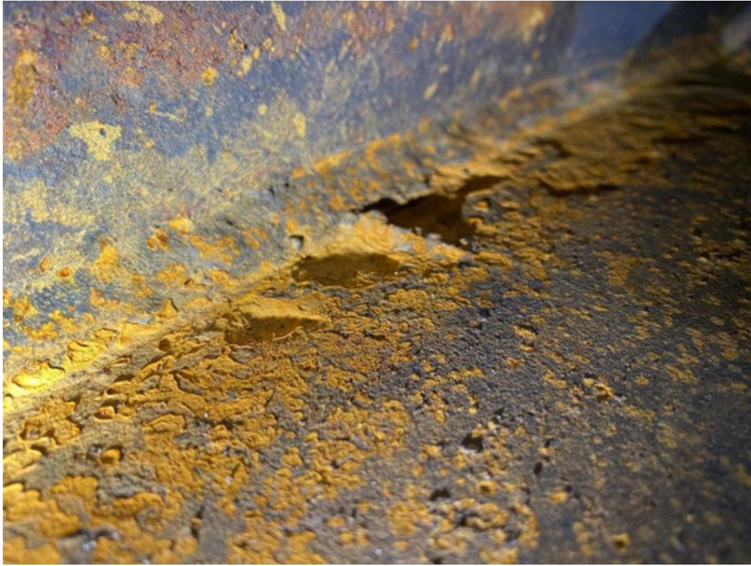
Mynd 8. Annar pittur. Þessi var 1.8-2 mm á dýpt Staðsettur á plötu 6 alveg við kverkina. 300mm frá plötu 5 og upp við umfar 4. 10x20mm á stærð
