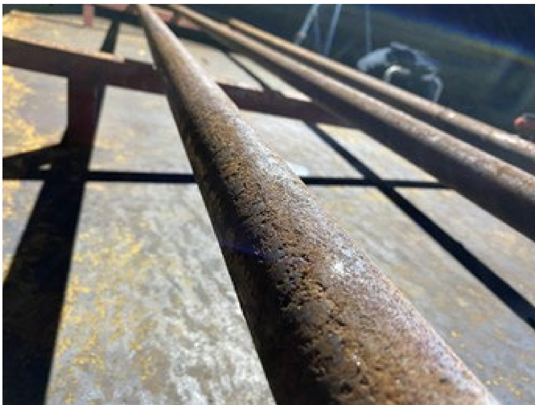
Mynd 10. pyttamyndun á öllum spirálnum, er ekki djúpt en eitthvað til að hafa í huga.
