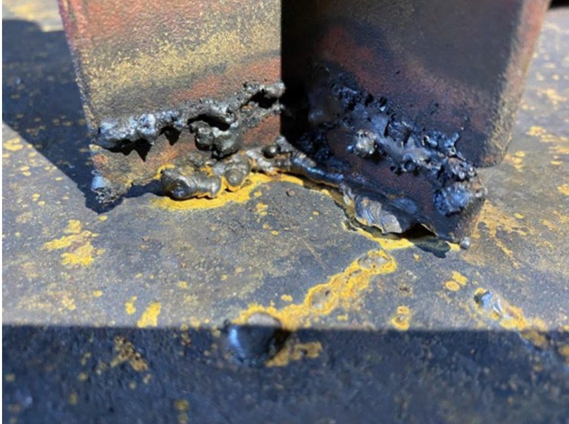
Mynd 2. Hérna sést hvernig undirstöðurnar fyrir spíralinn eru ekki heilsoðnar og eru eiginlega bara hálf lausar frá botni geymisins.
