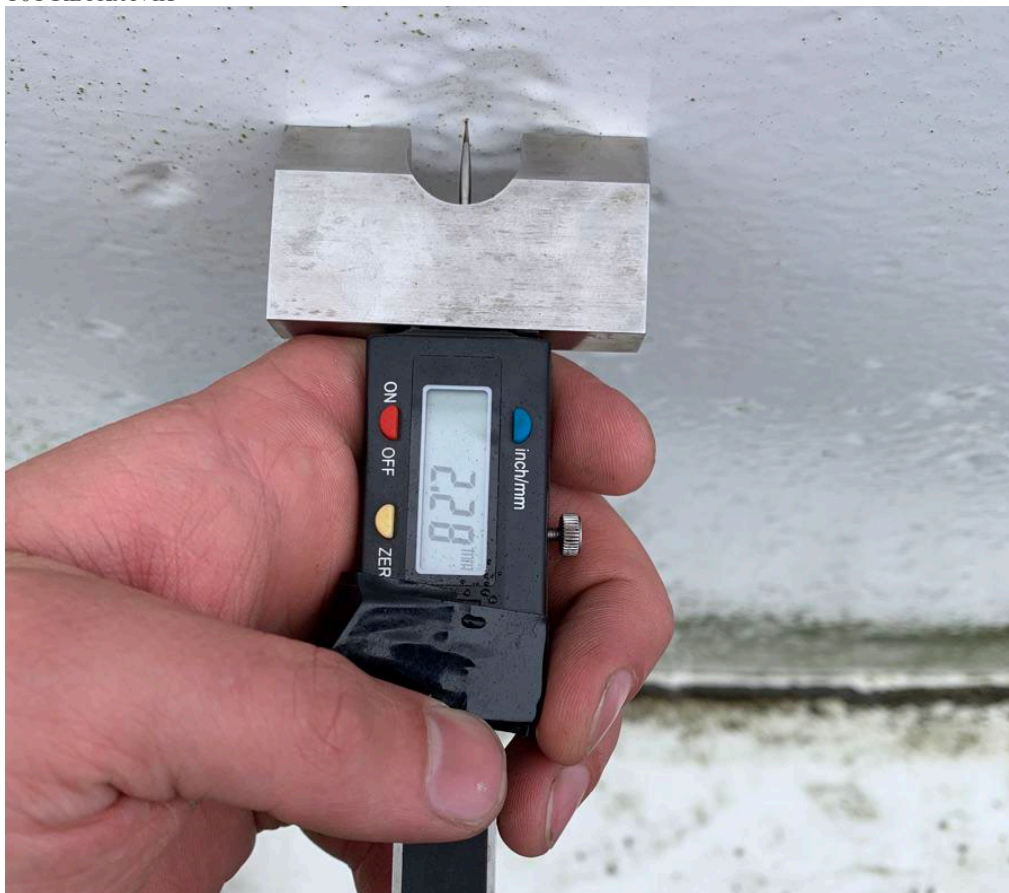
Mynd 9. Víða má finna rúmlega 2mm djúpa pytti utanvert.
