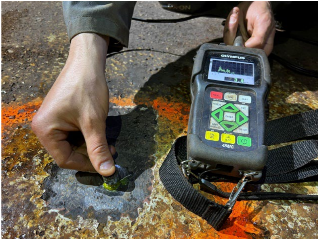
Mynd 5 & 6. Í plötu 32 fannst einn djúpur pyttur í 6.0mm þykkri plötu. Þykkarmælir sýnir 3,4mm efnisþykkt plötu sem er yfir viðmiðunarmörkum.
