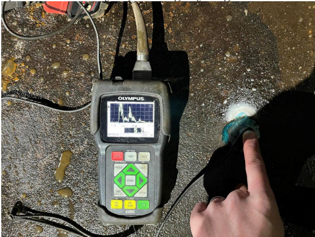
Mynd 9. Þau svæði sem skanni gaf tilkynna um efnisþynningu voru þykktarmæld.
