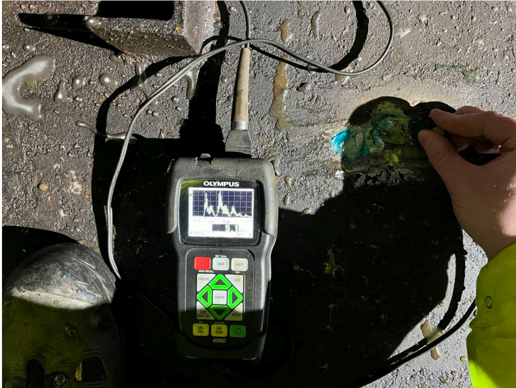
Mynd 8. Þau svæði sem skanni gaf tilkynna um efnisþynningu voru þykktarmæld.
