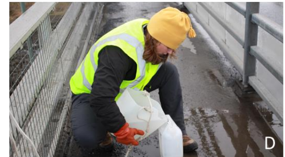
Mynd 7. A-D. Sýnasöfnun í Ölfusá 6. A) Yfirlitsmynd yfir söfnunarstaðinn 24. ágúst 2020 (mynd: SBÞ). B) Mikið vatn var í ánni þegar safnað var 17. mars 2021 (mynd: SBÞ). C) Svifaurssýnin eru tekin með svifaurssýnataka í spili og þarf aðstoð lögreglu við að stjórna umferð á meðan (mynd: ESE). D) Vatnsefnasýnin eru tekin í fötu af brúnni við Selfoss (mynd: Deirdre Clark)
