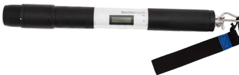
Mynd 6. Dæmi um handmæli sem mælir endurkast ljóss af þörungum á botni í straum- og stöðuvötnum (BenthosTorch, bbe moldaenke). Ljósmynd: Svanhildur Egilsdóttir
